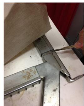
**Tension finale** : il s'agit de placer et percer définitivement la toile régulièrement dans les crans métalliques sur les 4 côtés.
