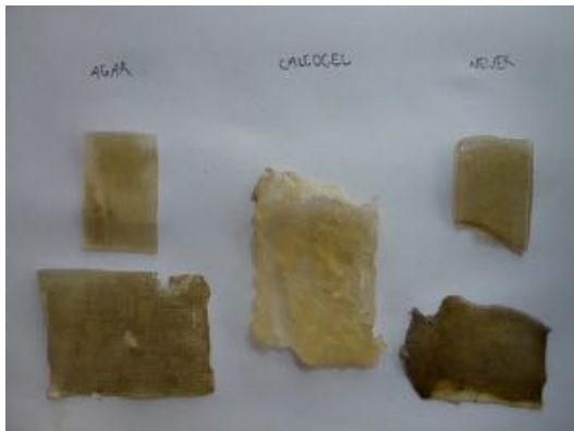
Tests réalisés avant l'application des gels, afin d'en définir la meilleure utilisation ©CB
