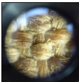
Toile vue au microscope, grossissement x100 Vue mettant en valeur la régularité du tissage de la toile ©CB
