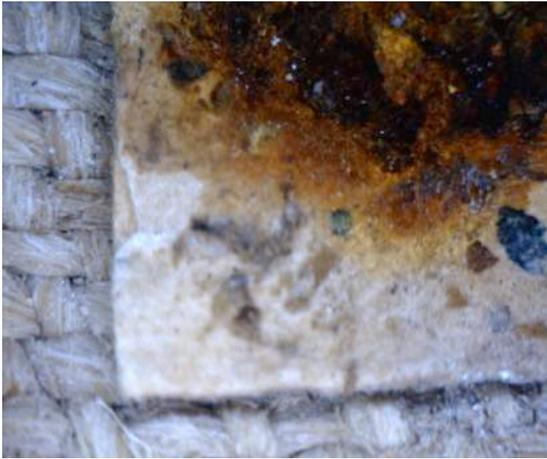
Vue microscopique de l'oxydation des papiers de protection des semences
